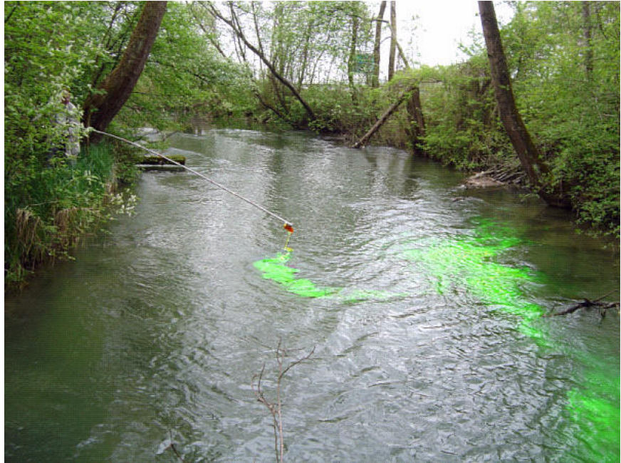
Abflussmessung Alte Aare bei Lyss. Durch Schwenken des Gestänges während der Tracereingabe wird die Durchmischung gefördert. Am wichtigsten ist aber, dass der Hauptteil des Tracers in den Stromstrich eingegeben wird.
