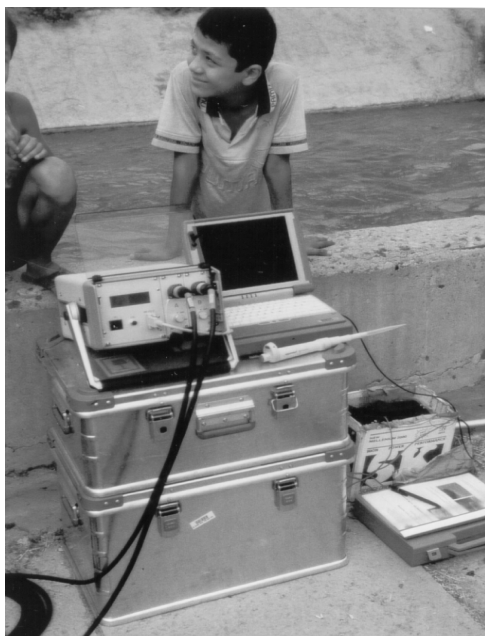
Das Lichtleiterfluorimeter der Schweizerischen Landeshydrologie im Einsatz in Taschkent (Usbekistan) im Sommer 2001. Damit wurden Abflussmessungen nach der Tracerverdünnungsmethode durchgeführt (Kapitel 13). Das Gerät ermöglicht die kontinuierliche Registrierung der Konzentrationen von Fluoreszenztracern. Allerdings ist die Ausrüstung ziemlich schwer, unter anderem wegen dem Bleiakku (rechts im Bild). Heute gibt es auch kleinere Geräte. Die Auswahl auf dem Markt ist aber sehr klein.
